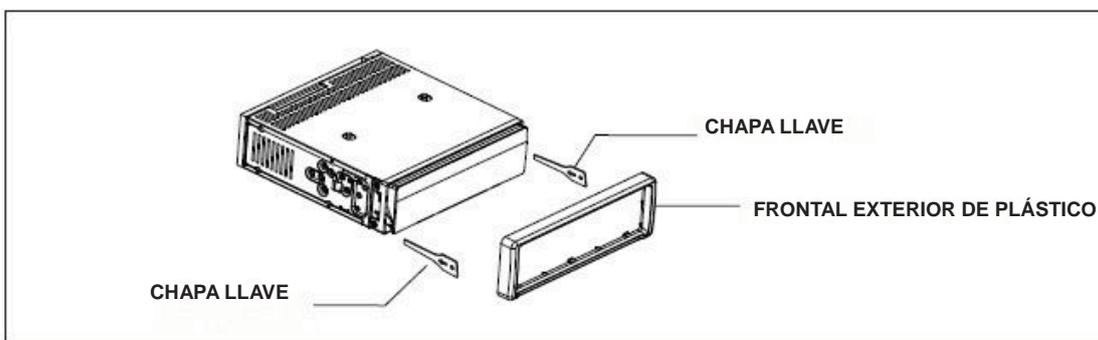
Si desea extraer el CHASIS de la CAJA DE SOPORTE DESLIZANTE, retire en primer lugar la CUBIERTA DE PLÁSTICO a ambos lados, y a continuación inserte las dos CHAPAS DE LLAVE en los lados izquierdo y derecho del chasis como se muestra arriba.
