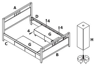
TURN LEVELER UNDERNEATH STORAGE FEETS  $(\mathbf{H})$  TO ADJUST THE STORAGES  $(\mathbf{G})$  LEVEL AS SHOWN ON ILLUSTRATION.
