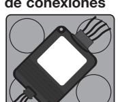
Se monta en una caja de conexiones estándar de 102 mm x 102 mm (4 pulg x 4 pulg) a través de una tapa ciega, con un manguito rosado de 13 mm (1/2 pulg) y contratuerca. Dimensión recomendada es de 762 mm<sup>3</sup> (30 pulg<sup>3</sup>).
