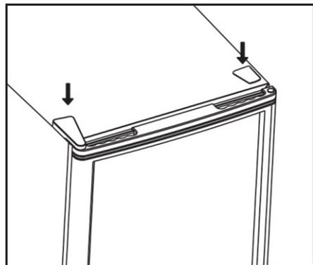
13. Con la puerta cerrada, verifique que la puerta esté alineada horizontalmente y verticalmente y que las juntas estén cerradas por todos los lados antes de, finalmente, ajustar la bisagra inferior. Vuelva a ajustar las patas niveladoras según sea necesario.
