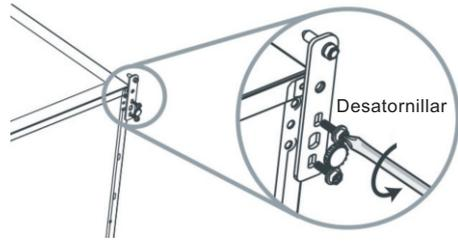
7. Desatornille y retire el pasador de la bisagra inferior, gire el soporte y reemplácelo.
