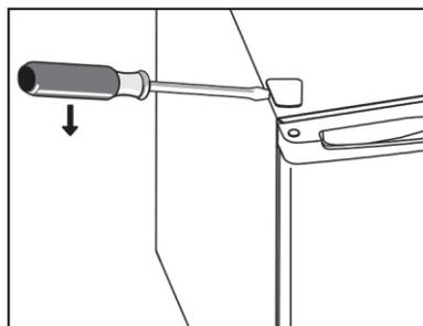
5. Mueva la cubierta central del lado izquierdo al lado derecho. Levante la puerta y colóquela sobre una superficie acolchada para evitar que se raye.
