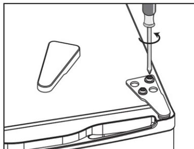
4. Retire la cubierta del tornillo superior izquierdo.
