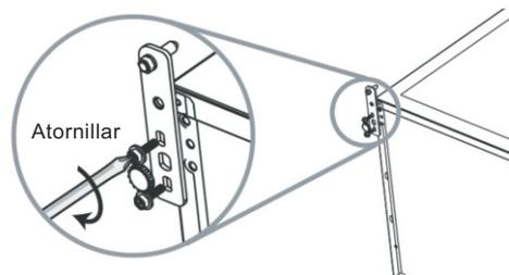
9. Coloque la puerta nuevamente. Asegúrese de que la puerta quede alineada horizontalmente y verticalmente para que las juntas estén cerradas por todos los lados antes de, finalmente, ajustar la bisagra superior.
