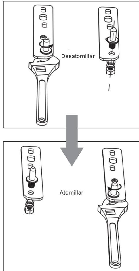
8. Vuelva a colocar el soporte para que encaje con el pasador de la bisagra inferior. Vuelva a colocar ambas patas ajustables. .
