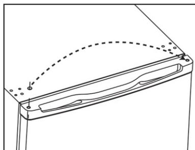
6. Retire los tornillos y la bisagra inferior. Luego, quite las patas ajustables de ambos lados.
