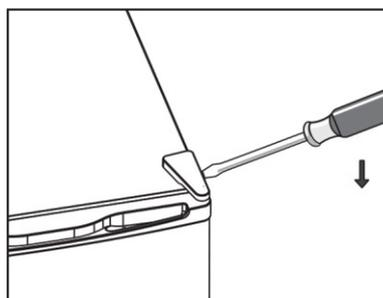
3. Afloje los tornillos. A continuación, retire el soporte de la bisagra.
