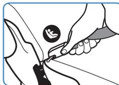
Attacher un connecteur d'ancrage de ceinture SAU à l'ancrage situé dans l'anse du siège du véhicule.
