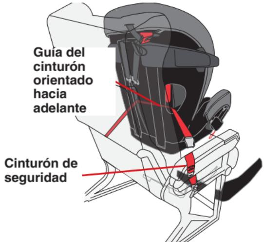
2. Pase el cinturón de seguridad del avión a través de la abertura de la guía del cinturón orientado hacia adelante en el respaldo del sistema de sujeción infantil y continúe a través de la abertura de la guía del cinturón en el lado opuesto del sistema de sujeción infantil.
