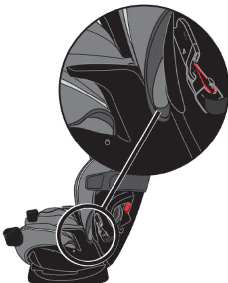
5. Vuelva a colocar el acojinado de la cabecera. Pase la correa de sujeción a través de la ranura en la parte posterior del acojinado del respaldo.
