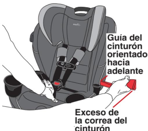
su peso, empuje el sistema de sujeción infantil firmemente contra el asiento del avión, mientras jala el exceso de la correa del cinturón de seguridad para apretarlo.
