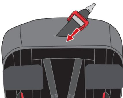
6. A cada lado del acojinado del respaldo, retire las esquinas del acojinado de la estructura del asiento.
