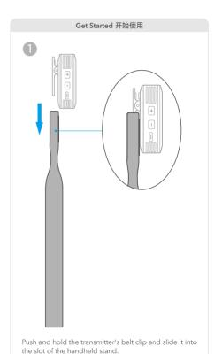
按压住发射器的背夹,将发射器固定在手持支架上。
