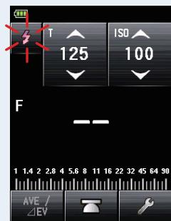
7. 当测量模式图标 (
