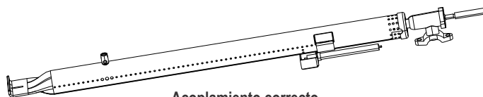
Acoplamiento correcto del quemador con la válvula
