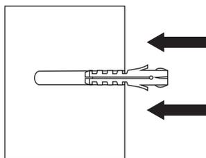
**3.** Vissez un boulon de fixation dans chaque cheville à l'aide d'une clé de 8 mm jusqu'à ce que la clé soit en contact avec le mur.
