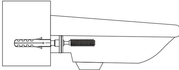
5. Vissez un écrou en métal sur chaque boulon de fixation pour fixer le lavabo. Ne pas trop serrer car cela pourrait abîmer la céramique.
