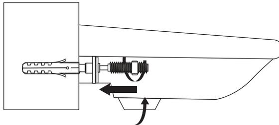
6. Assurez-vous que le lavabo est bien fixé, serrez les boulons si nécessaire. Installez le robinet et le drain en suivant les instructions du fabricant. Raccordez le robinet à l'alimentation en eau et vérifiez qu'il n'y a pas de fuites.
