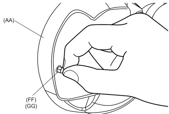
**7** Une fois le luminaire solidement fixé à la J-Box, appliquez un mastic silicone autour de la base du luminaire pour empêcher l'eau de s'infiltrer dans la boîte.
