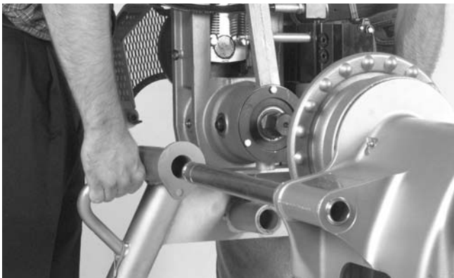
Figure 4 – Montage de la rainureuse sur les bras de montage
