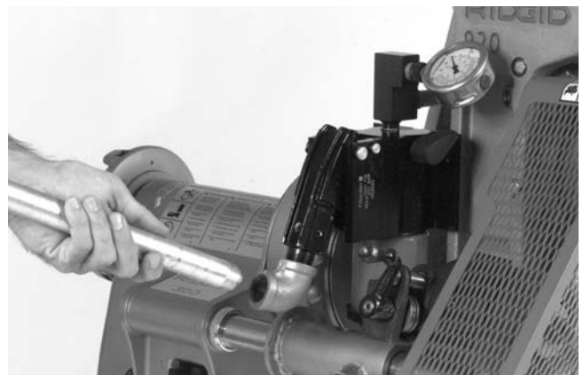
Figura 8 – Instalación de la manivela de la bomba
