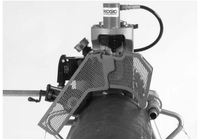
Figura 14 – Cubiertas en posición de funcionamiento
