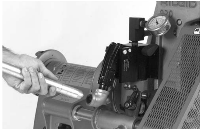
Figure 8 – Installation du levier de pompe
