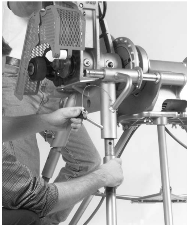
Figura 23 – Extracción de las patas, fuera de la base de la máquina
