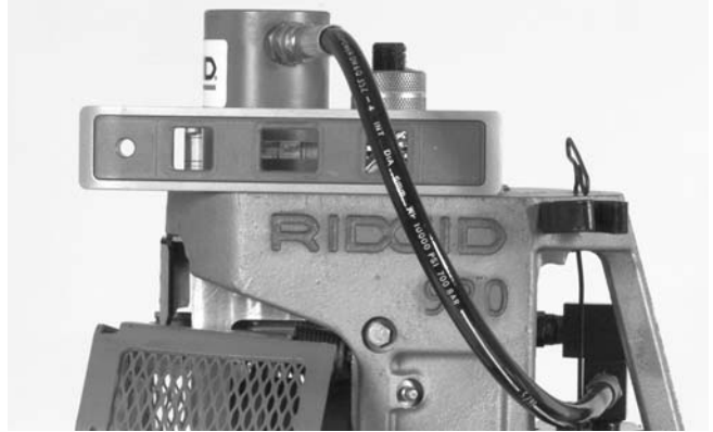
Figura 7 – Nivelación de la Ranuradora
