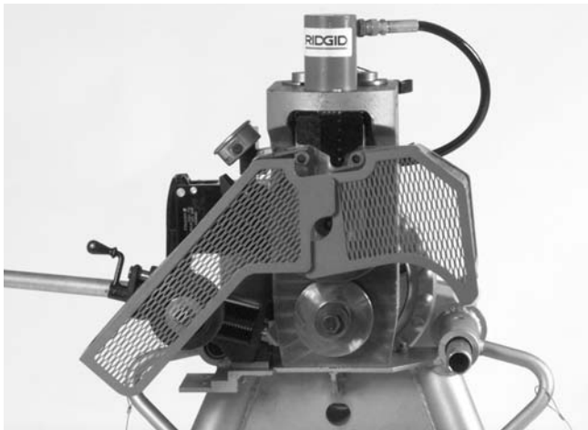
Figura 13 – Cubiertas en posición abierta
