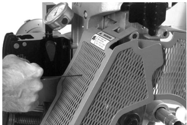
Figure 18 – Desserrage de la vis de calage du logement de galet supérieur
