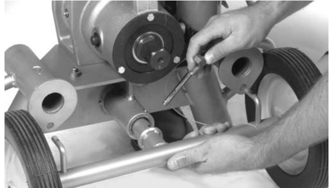
Figure 24 – Montage de la rainureuse sur l'essieu de transport n° 32
