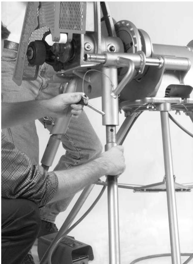
Figura 5 – Colocación de las patas en la base de la Ranuradora
