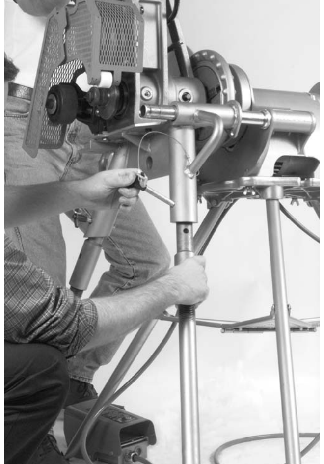
Figure 5 – Installation des pieds dans l'embase de la rainureuse
