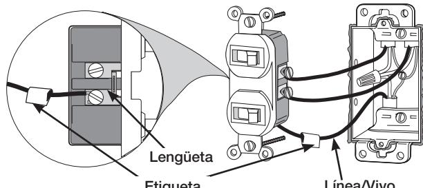
**4 Retire las secciones centrales (si se agrupan dispositivos)**
