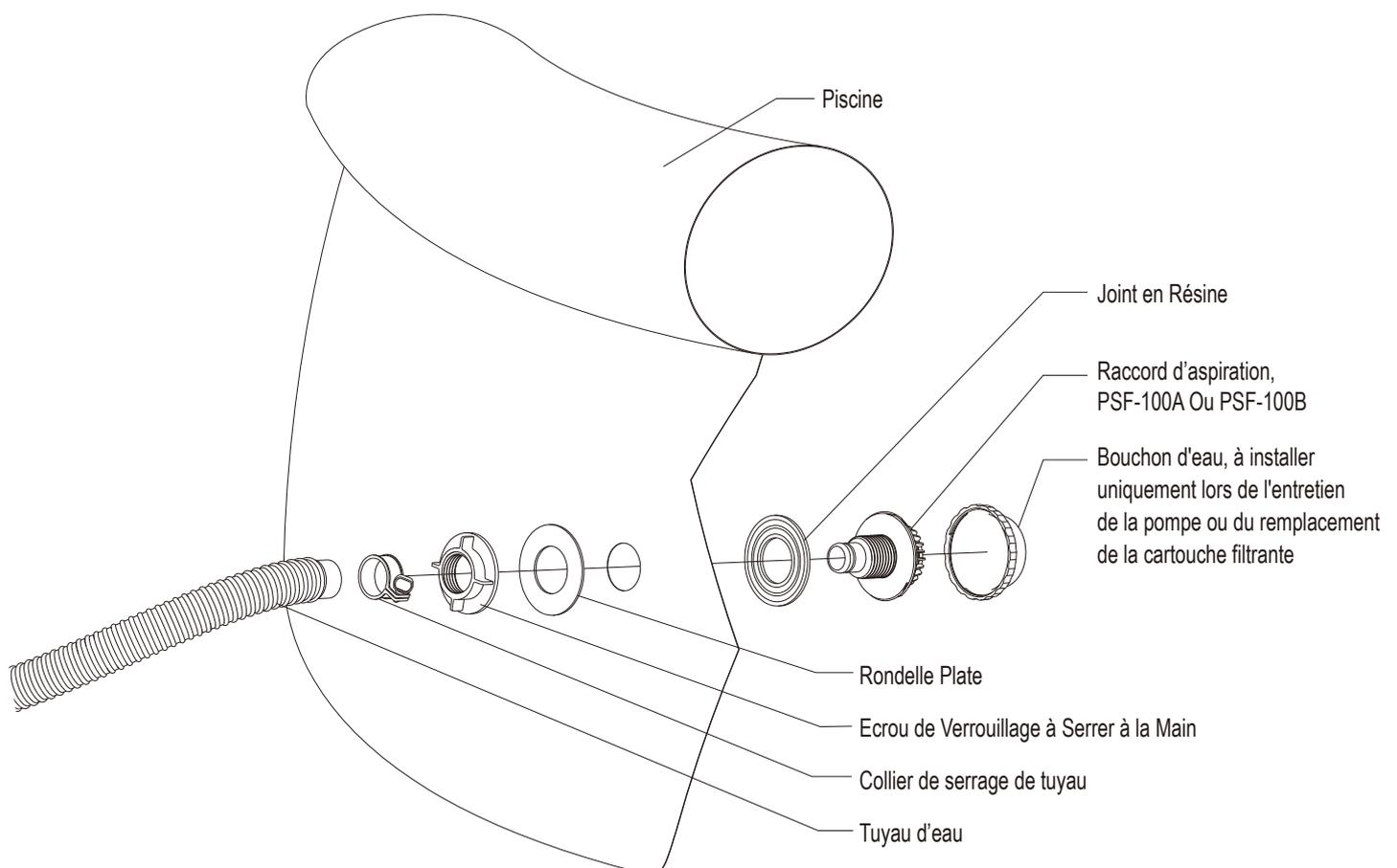
9. L'orifice d'aspiration de type PSF-100A ou PSF-100B doit être remplacé chaque 5ans.
