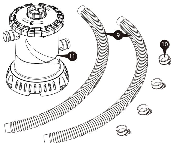
5. Brancher le raccord d'aspiration **2** à l'entrée de la pompe avec un tuyau et une bride à chaque bout. S'assurer que les colliers de serrage de tuyau **10** scellent hermétiquement par-dessus à la fois le tuyau de refoulement **9** et les joints toriques **7**.
