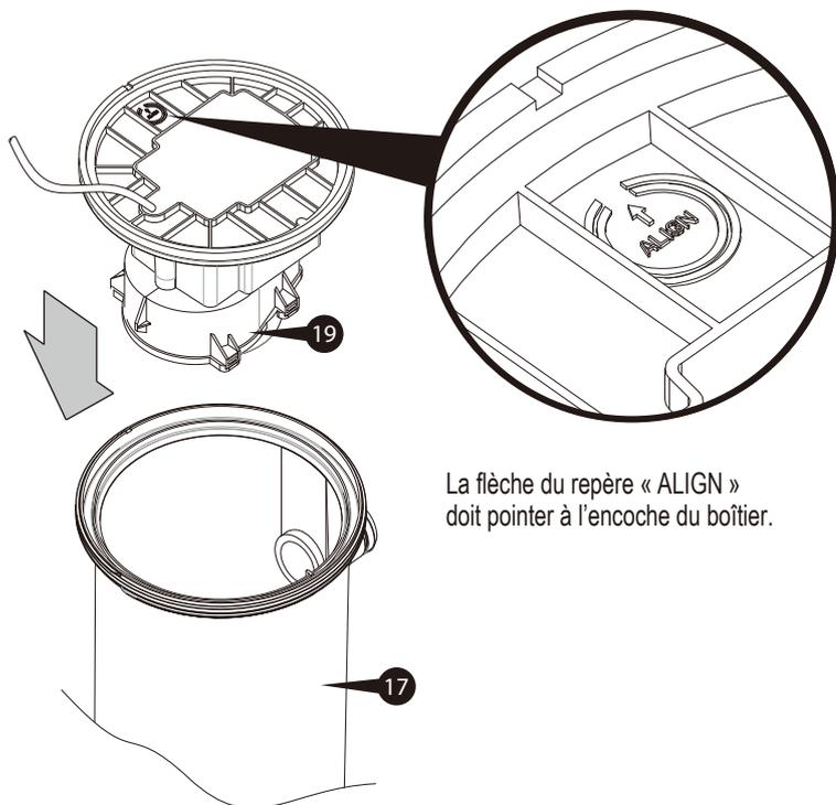
La flèche du repère « ALIGN » doit pointer à l'encoche du boîtier.
