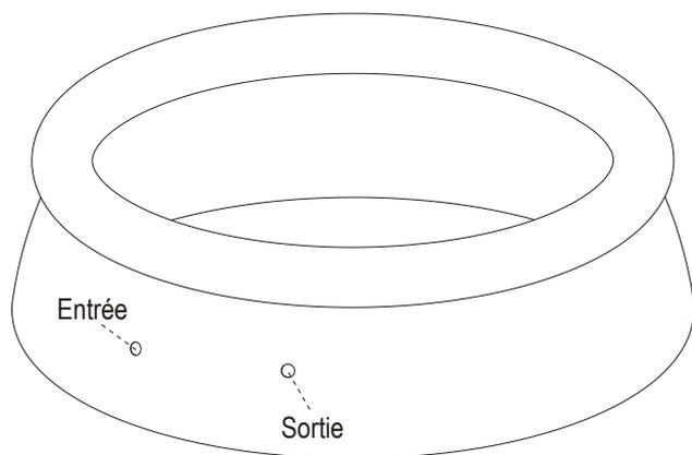
2. À partir de l'intérieur de la piscine, installer le raccord de refoulement **2** dans l'ouverture de la sortie.
