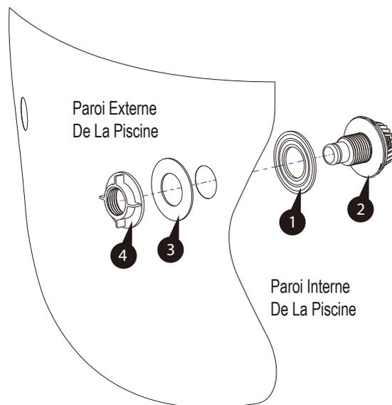
3. À partir de l'intérieur de la piscine, installer le raccord de refoulement **6** dans l'ouverture de l'entrée.
