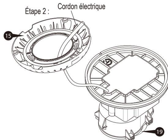
3. Lentement réinsérer le moteur dans le boîtier. Il y a une rainure sur le fond du moteur (marquée « ALIGN »). S'assurer que la rainure s'aligne avec l'encoche sur le boîtier (seulement visible à partir du fond), sinon la base de la pompe pourrait fuir même si elle est déjà verrouillée en place. La buse en caoutchouc 18 doit également être alignée avec la sortie d'eau du boîtier.
