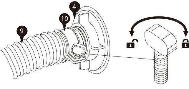
9. Procéder à l'aération de la pompe : pour dégager l'air emprisonné à l'intérieur et s'assurer d'un débit d'eau fluide, il est important d'aérer ou de dépressuriser la pompe avant chaque utilisation. Il suffit de faire tourner dans le sens inverse des aiguilles d'une montre pour desserrer la vis évent **12**, et la pression de l'eau dégagera tout l'air emprisonné. Resserrer la vis une fois l'eau se met à couler.
