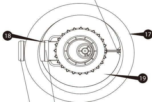
S'assurer que la buse en caoutchouc 18 est alignée avec la sortie du boîtier.
