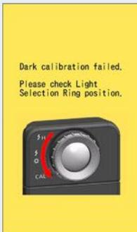
Die Dunkel-Kalibrierung wurde durchgeführt, konnte jedoch nicht normal abgeschlossen werden. Stellen Sie den Licht-Auswahl-Ring ② erneut auf die Position Dunkel-Kalibrierung **CAL** (👉) und wiederholen Sie die Dunkel-Kalibrierung.
