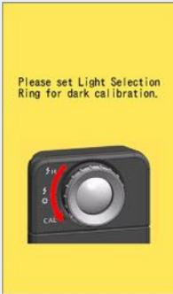
Der Licht-Auswahl-Ring ② ist auf die Reichweite H (⚡) (☀️) oder die Reichweite L (⚙️) (🌑) eingestellt, und die Dunkel-Kalibrierung konnte nicht durchgeführt werden.
