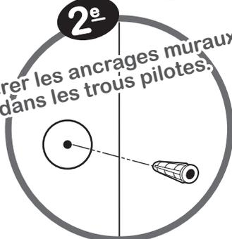
Remarque : En cas de montage sur du plâtre ou une cloison sèche, suivre cette étape et utiliser les ancrages muraux fournis.
