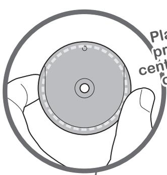
Placer un tampon de protection murale au centre de chaque contour circulaire sur le mur.
