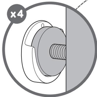
Répéter les étapes d'installation de la page 5. Les 4 boulons de tension reposeront à l'intérieur de chaque tampon de protection murale.
