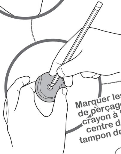
Marquer les orifices de perçage avec un crayon à travers le centre de chaque tampon de protection.
