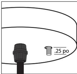
REMARQUE: Positionnez la barre transversale sur la boîte de jonction pour déterminer la longueur de réglage de la vis en fonction du niveau de la boîte de jonction (encastré ou dépassant du plafond). Placer momentanément la canopée au-dessus de la barre transversale et s'assurer que les vis dépassent de 0,25 pouce de la canopée.
