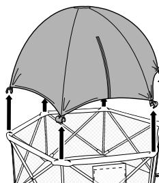
Pour retirer et ranger la capote, enlevez les attaches, posez la capote sur le sol et, les mains placées sur le dessus de la capote, appuyez vers le bas. La capote s'aplatis.
