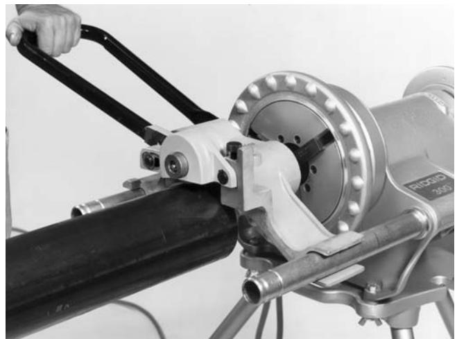
Figura 12 – Formación de una ranura a rodillo
