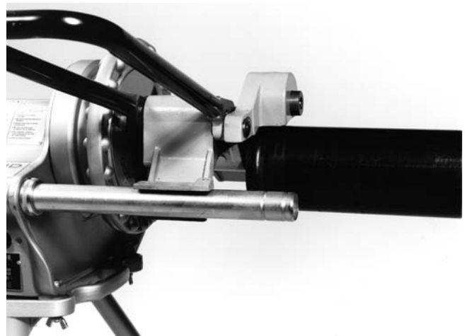
Figure 6 – Equerrage du tuyau et du porte-tubes
