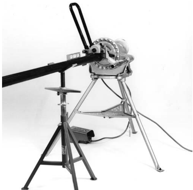
Figure 7 – Nivellement du tuyau.
