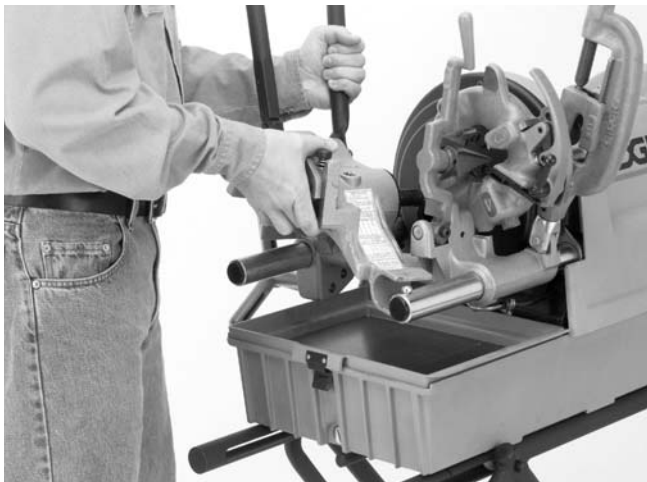
Figure 4 – Montage sur machine à fileter n° 1822-I (idem pour les machines à fileter 300 Compact et 535)
