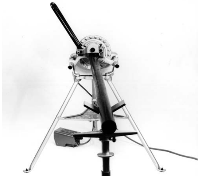
Figure 8B – Utilisation de la machine en MARCHE AVANT (FOR)
