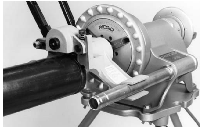
Figure 9 – Levier d'avancement en position relevée
