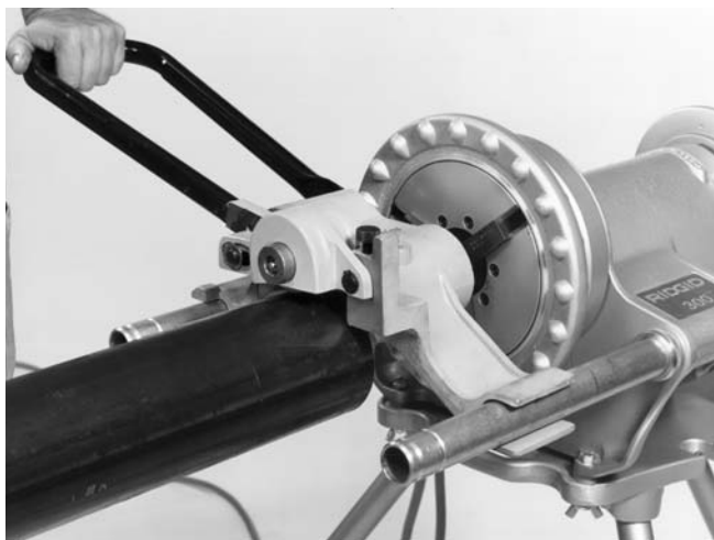
Figure 12 – Exécution du rainurages
