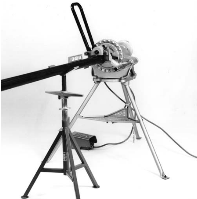
Figura 7 – Nivelación del tubo
