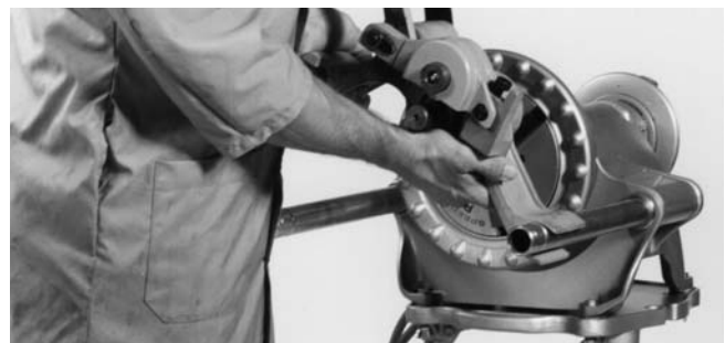
Figura 2 – Montaje sobre el Accionamiento motorizado No. 300
