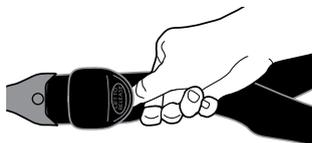
Incline y deslice el ajustador para aflojar el ensamblaje de conectores de anclaje inferior.
