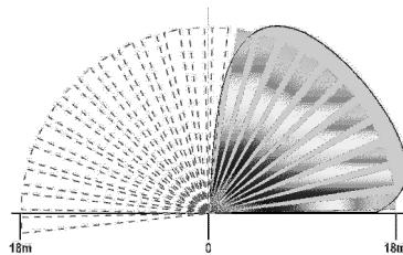
Para cambiar la dirección del haz de detección, gire la caja de protección del elemento de detección interno a la posición deseada.
