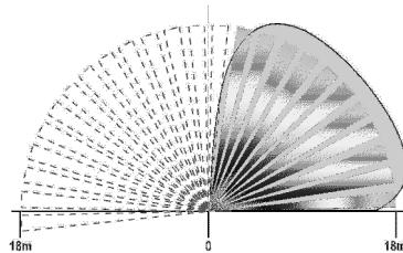
Para mudar a direcção do feixe de detecção, rode a caixa de protecção do elemento de detecção interno para a posição desejada.
