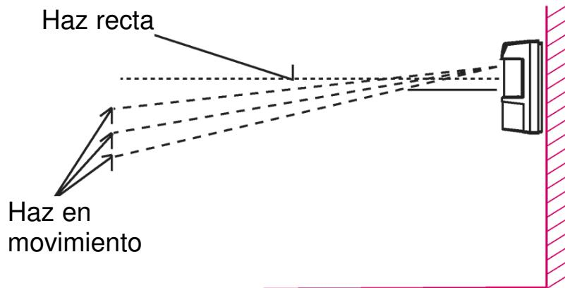
Para alterar el alcance de detección, desplace el elemento de detección superior hacia arriba o hacia abajo.
