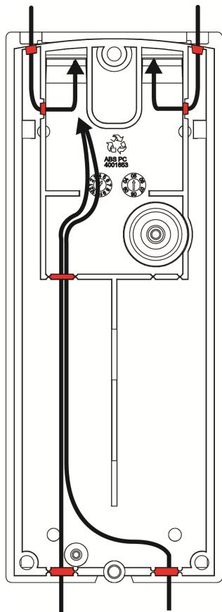
10. Coloque a esponja vedante em formato de "U" à abertura de passagem dos fios da parte traseira depois de os fios estarem ligados e antes da fixação final do produto no suporte montado.
