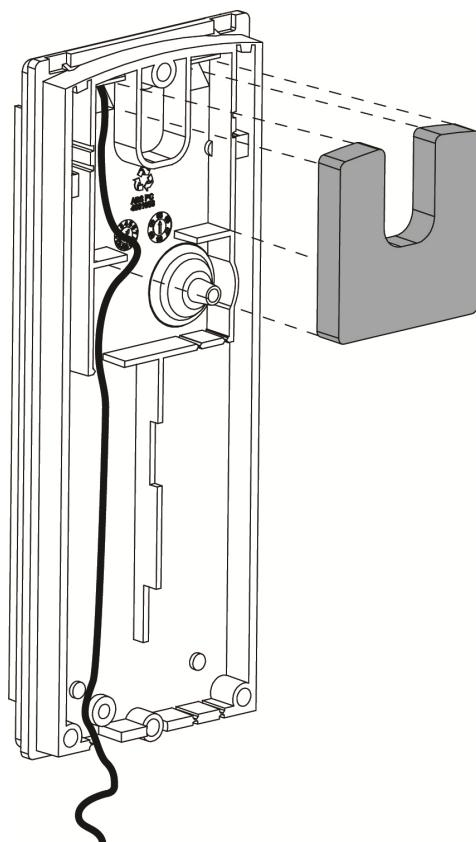
11. Placez le détecteur sur le support de montage du haut vers le bas, puis verrouillez avec la vis de blocage en bas.
