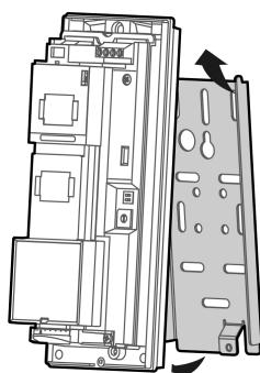
8. Fije el soporte trasero a la pared o a un poste utilizando tornillos de montaje o tiras de metal.
