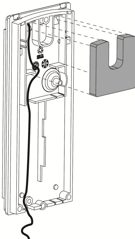
11. Coloque o detector no suporte de montagem de cima para baixo e fixe o parafuso na parte inferior.
