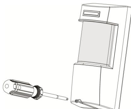
6. Suelte el soporte de metal trasero destornillando el tornillo inferior interno.
