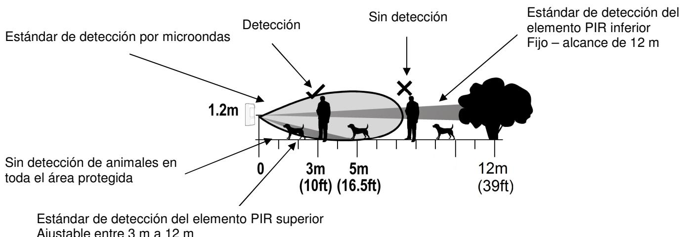
El LC-171 es capaz de diferenciar cuerpos de animales domésticos y humanos y enviar alertas según el tipo que sea detectado, utilizando la detección de movimiento por microondas aliada a dos haces de detección por PIR.
