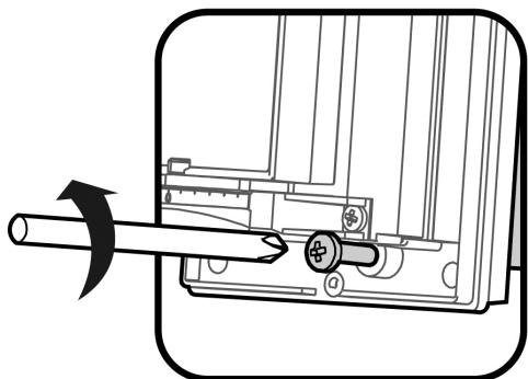
7. Suelte el cuerpo del detector del soporte de metal tirando el detector hacia afuera y hacia arriba.
