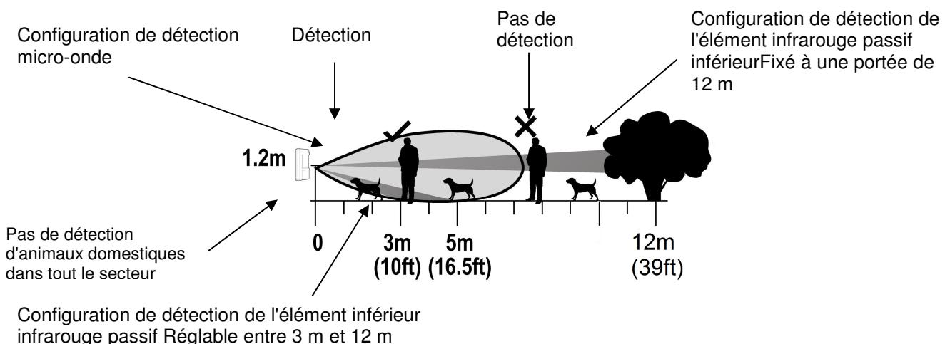
Le LC-171 peut distinguer le corps des animaux domestiques du corps humain et alerter en conséquence en combinant la détection du mouvement microonde et deux faisceaux de détection à infrarouge passif.
