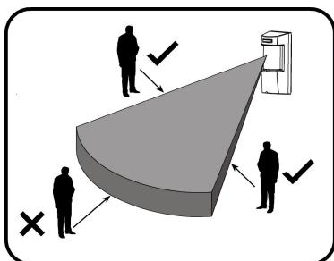
2. El detector se debe instalar a una altura de 0,8 a 1,5 metros (la altura ideal es 1,2 m).
