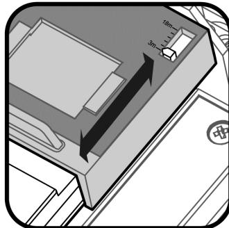
Pour régler pour des portées situées entre 2 et 12 m, faites glisser l'élément de détection vers le haut ou vers le bas pour correspondre à la distance désirée. Chaque degré entre 3 m et 12 m représente une portée de 3 m.
