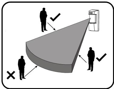
2. Il rilevatore deve essere installato a un'altezza di 0,8-1,5 metri (l'ideale è 1,2 m).
