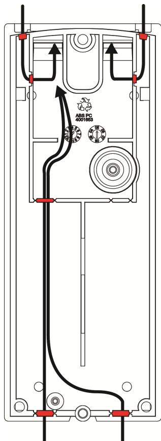
10. Acople la esponja de veda en formato de "U" a la apertura de paso de los hilos de la parte trasera después que los hilos estén conectados y antes de la fijación final del producto en el soporte montado.
