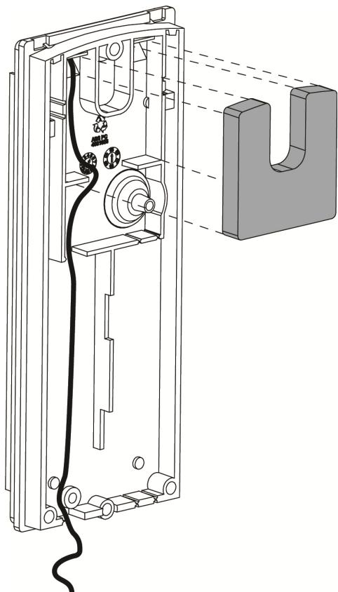
11. Posizionare il rilevatore sulla staffa di montaggio dal lato superiore verso il basso e fissare quindi la vite nella parte posteriore.
