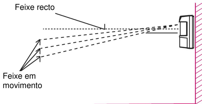
Para alterar o alcance de detecção, deslize o elemento de detecção superior para cima ou para baixo.
