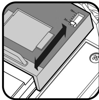
Para ajustar alcances entre 3 m y 12 m, desplace el elemento de detección hacia arriba o hacia abajo según la distancia deseada. Cada etapa entre 3 m y 12 m representa 3 m de alcance.
