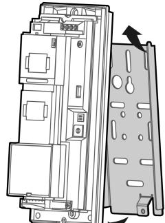
8. Fissare la staffa posteriore alla parete o a un palo usando le viti di montaggio o le fascette metalliche.
