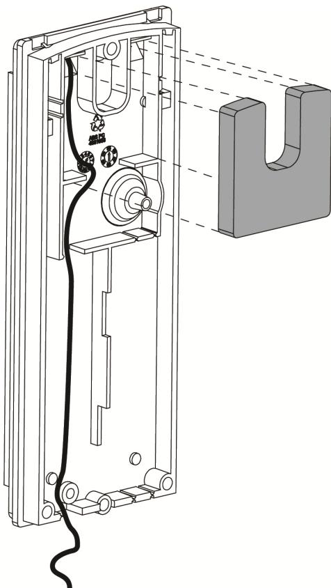
11. Coloque el detector en el soporte de montaje de arriba hacia abajo y fije el tornillo en la parte inferior.
