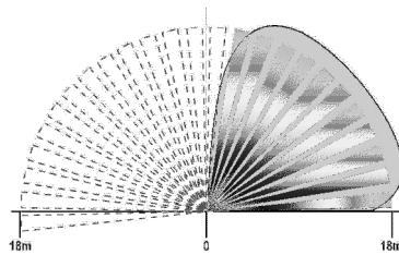
Pour changer la direction du faisceau, tournez le boîtier de l'élément de détection interne dans la direction désirée.
