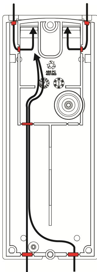
10. Fixez le joint de mousse en U à l'ouverture pour le fil du côté arrière après que les fils ont été connectés et avant de fixer définitivement le dispositif au support installé.
