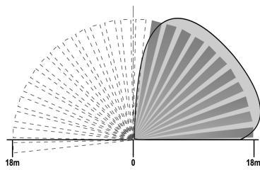
Per modificare la direzione del fascio di rilevamento, ruotare l'alloggiamento dell'elemento di rilevamento interno nella direzione desiderata.
