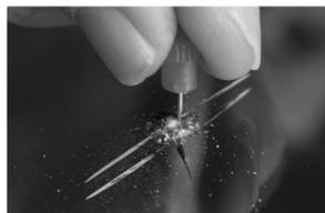
2. **Remplissage de petites zones piquées ou rayées :** Retirez le bouchon de la résine de réparation (1) et appliquez une ou deux gouttes sur la zone endommagée. Appliquez rapidement une bande de durcissement (2) sur la résine et la zone endommagée. Cela permettra de maintenir la résine en place pendant qu'elle durcit.
