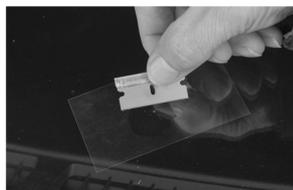
4. **Finition :** Une fois que la résine a complètement durci, retirez avec précaution la bande de durcissement. Utilisez le rasoir de sécurité (3) pour enlever tout excès de résine de réparation. Utilisez un chiffon propre et une solution pour essuyer les empreintes digitales et les taches sur le pare-brise. Votre réparation est terminée.
