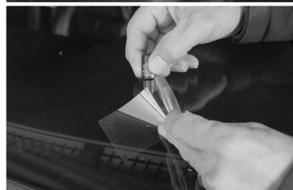
**REMARQUE :** *Il n'est pas nécessaire d'exercer une pression pour appliquer le film de durcissement sur la réparation. Il suffit de le placer délicatement sur le verre et d'utiliser une lame de rasoir (3) pour aider la résine à se répandre et à éliminer les bulles d'air à l'intérieur.*
