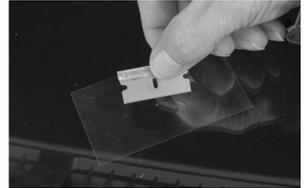
4. **Acabado:** Cuando la resina esté totalmente curada, quite con mucho cuidado la lámina de curado. Use la maquinilla de afeitar de seguridad (3) para quitar cualquier exceso de resina de reparación. Limpie las huellas dactilares y las manchas del parabrisas con un paño limpio y una solución. Ya ha terminado la reparación.
