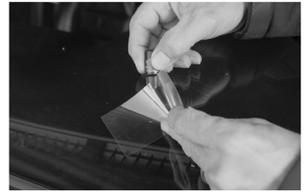
**AVISO:** Cuando se aplica la lámina de curado a la reparación, no es necesario presionar. Basta con colocarla suavemente sobre el cristal y usar una cuchilla de afeitar (3) para facilitar la extensión de la resina y eliminar las burbujas de aire del interior.
