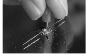
2. **Relleno de pequeñas zonas picadas o rayadas:** Retire el tapón de la resina reparadora (1) y aplique una o dos gotas en la zona dañada. Aplique rápidamente una tira de curado (2) sobre la resina y la zona dañada. Esto ayudará a mantener la resina en su lugar mientras se cura.
