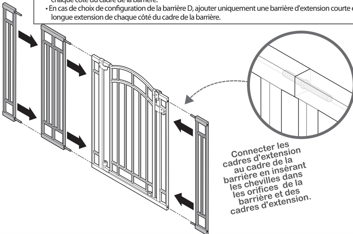
Connecter les cadres d'extension au cadre de la barrière en insérant les chevilles dans les orifices de la barrière et des cadres d'extension.
