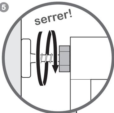
Utiliser les écrous de tension pour serrer les deux boulons de tension supérieurs.
