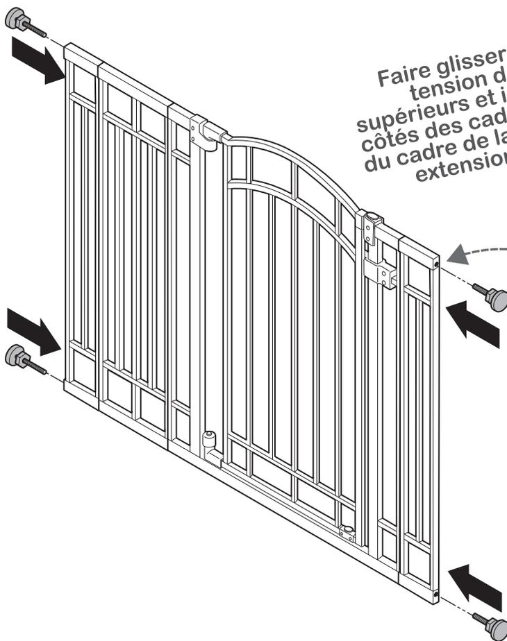
Faire glisser les boulons de tension dans les trous supérieurs et inférieurs des deux côtés des cadres d'extension (ou du cadre de la barrière si aucune extension n'est utilisée).
