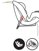
Ceinture du SAU et courroie d'attache Ne pas installer de cette manière pour un enfant pesant plus de 18 kg (40 lbs).
