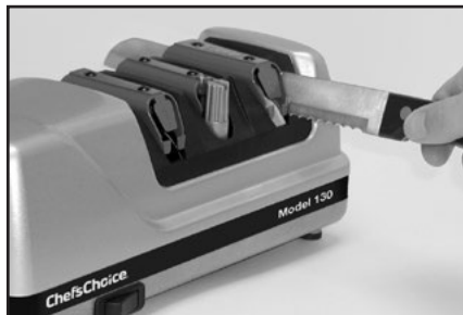
Figure 10. Aiguise les lames crantées uniquement dans la phase 3. (Voir les instructions).
