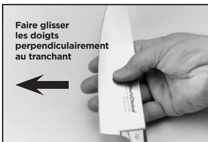
Figure 5. La bavure peut être décelée en faisant glisser les doigts perpendiculairement au tranchant en les éloignant du tranchant. Faites attention! Voir le texte.
