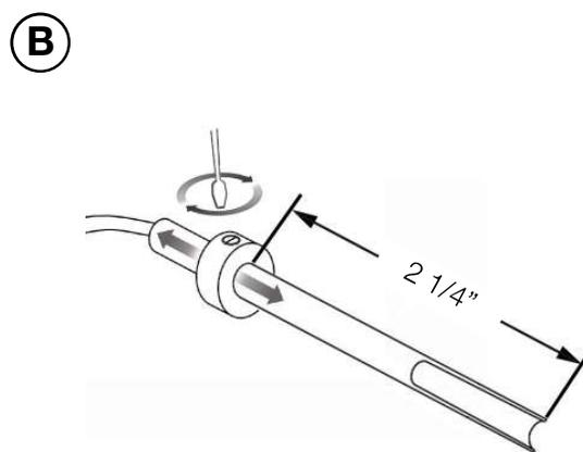
Régalez la profondeur à 2 1/4" et fixez-le avec la vis de réglage.
