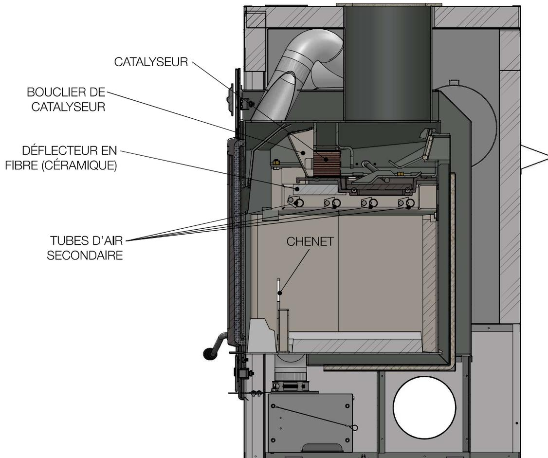
Le TZ3000H comporte un déflecteur en fibre de céramique, un catalyseur et un bouclier de la catalyseur. Il est important d'installer correctement chacun de ces composants avant d'utiliser l'appareil.
