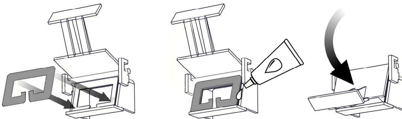
Appliquez un nouveau joint d'étanchéité en utilisant le ciment de poêle (non fourni) pour le-sécuriser. Ceci est d'éviter l'efflochage des extrémité et de fixer le joint d'étanchéité dans la position de l'encoche.
