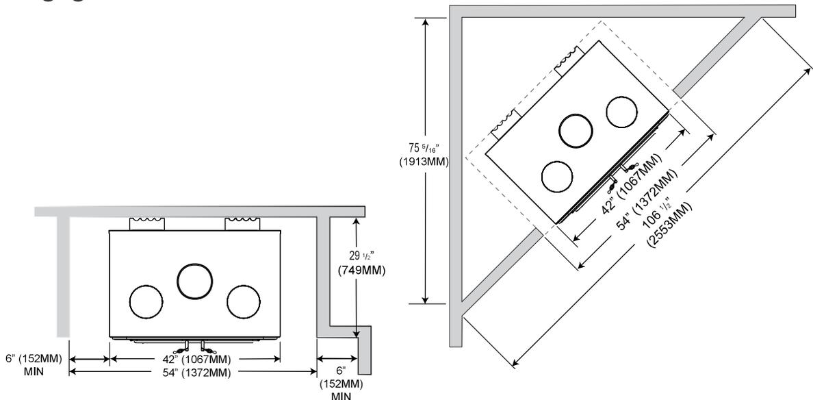
Un minimum de 6" (152mm) aux matériaux combustibles est requis à partir des côtés de l'appareil.
