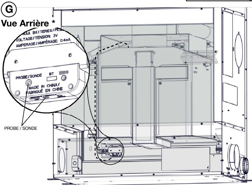
Fixez la sonde thermocouple vers le porte désigné sur le moniteur de température du catalyseur. Connectez qu'un thermocouple à l'appareil.
