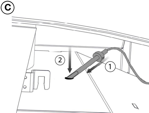
Insérez la sonde à un angle et progressivement redresser la sonde afin qu'elle est an panne.
