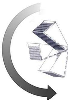
Réinstallez le panier perforé dans l'ordre inverse. Assurez-vous que le panier repose sur les boulons à épaulement de l'étape 2. Réinstallez le déflecteur en fibre.
