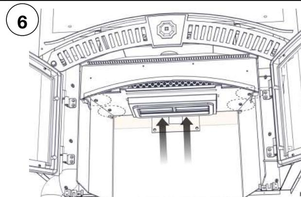
Retirez le collecteur d'air secondaire en le faisant glisser vers le bas et vers l'extérieur. Grattez le joint d'étanchéité de l'arrière puis nettoyez la surface. Fixez le nouveau joint d'étanchéité avec du silicone haute température (non fourni).
