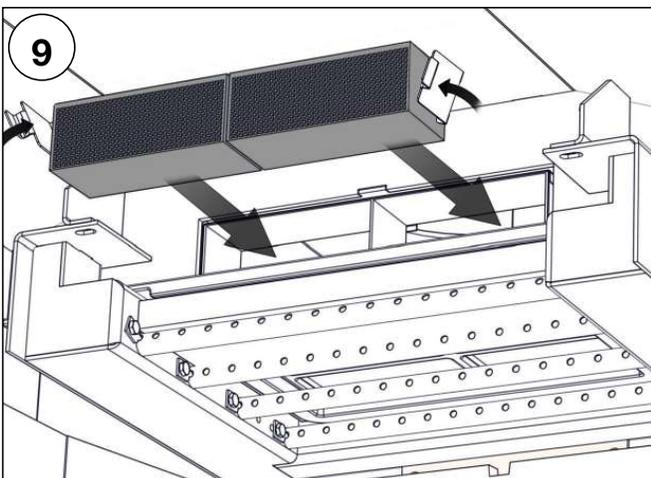
9 Tenez les languettes en acier situées de chaque côté du catalyseur et faites glisser le nouveau catalyseur à l'intérieur.
