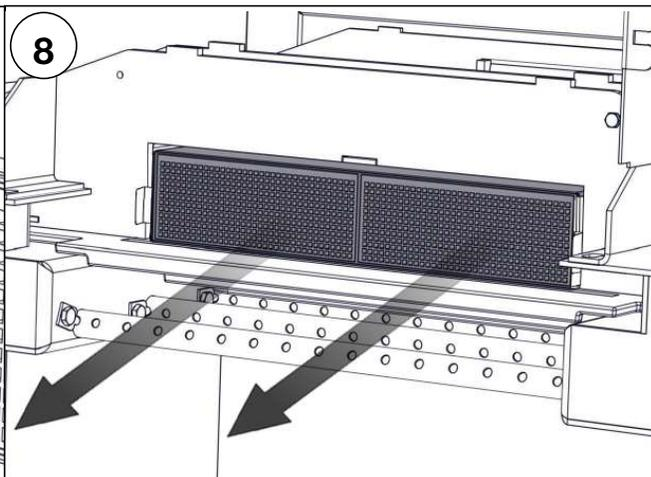
8 Sortez le catalyseur en le faisant glisser vers l'avant. Les languettes en acier sont retenues par friction et se séparent du filtre lorsque tiré.
