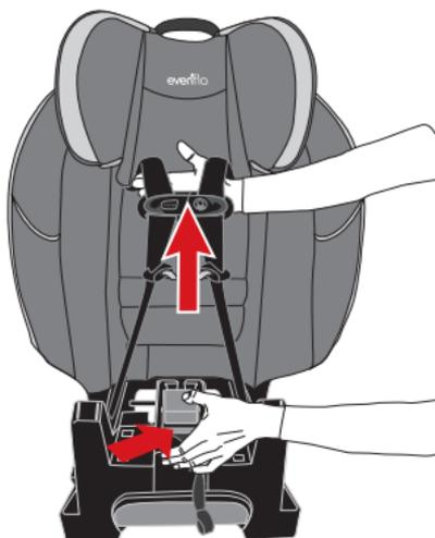
**REMARQUE :** Diminuer la sangle de réglage du harnais afin qu'elle mesure 3 po de long et la mettre par-dessus le bouton de désenclenchement du harnais. Rentrer le bout de la sangle dans la fente au-dessus du bouton de désenclenchement du harnais.
