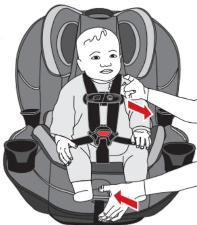
2. En appuyant sur le bouton, tirer sur les sangles du harnais. Pour détacher la pince de poitrine, appuyer sur le bouton de désenclenchement et tirer.
