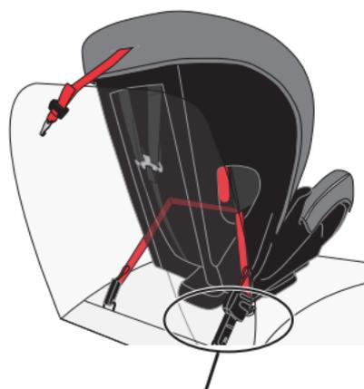
Serrer la sangle en actionnant la poignée du connecteur d'ancrage inférieur d'avant en arrière comme illustré jusqu'à ce que le siège soit fixe.
