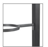
Anchor to the wall through the 4 holes. Ancrez au mur à travers les quatre trous. Fijar en la pared colocando los tornillos en los 4 orificios.
