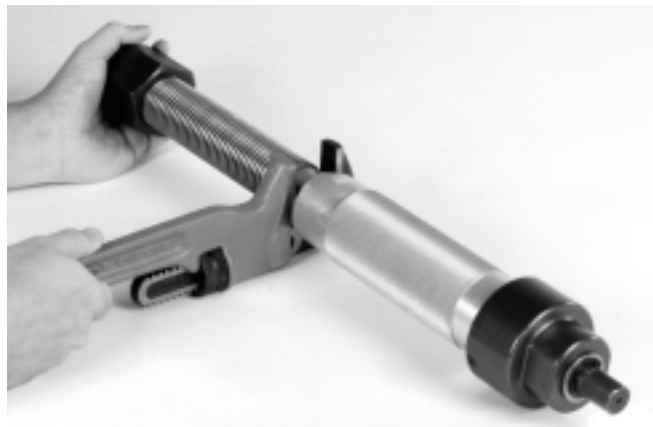
Figura 1 – Montaje del adaptador para válvula en el tornillo de alimentación
