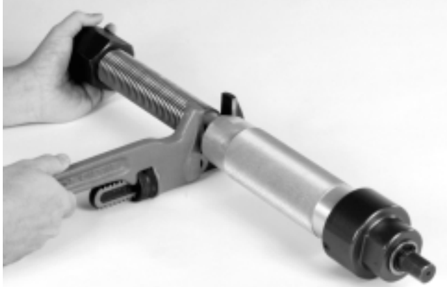
Figure 1 – Montage de l'adaptateur de vanne sur la vis d'alimentation
