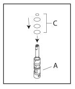
6. Usando la cápsula (D), lubrique las juntas tóricas nuevas (C).
