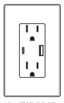
Output: USB-C: 5V---3A, 9V---2.22A, 12V---1.67A: 20W Max. USB-A: 5V---3A, 9V---2A, 12V---1.5A: 18W Max. USB-A + USB-C: 5V---3A, 15W Max
