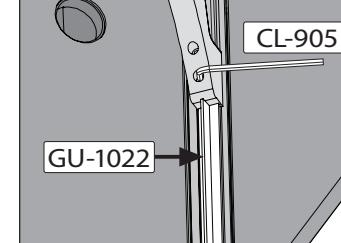
Installer les supports (SU-1016) sur les pattes à l'aide du guide (GU-1022) puis visser les 2 vis avec la clé (CL-905).
