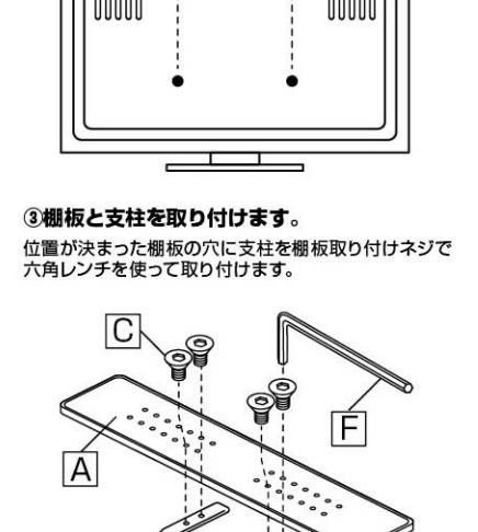
①左の写真の赤丸のようにテレビ背面（裏側）に4ヶ所以上ネジ穴が空いている。
