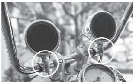
2. La abrazadera suministrada está preinstalada en la parte inferior del altavoz. Afloje la abrazadera a través de las tuercas de montaje.
