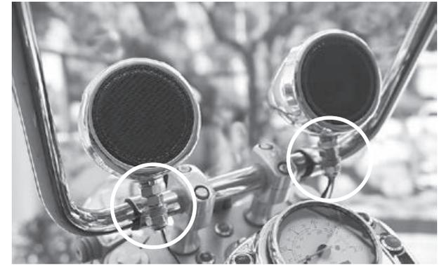
Encuentre una ubicación segura e ideal para el montaje. Asegúrese de que los altavoces no obstruyan la visión de los conductores ni ningún elemento de seguridad del vehículo.
