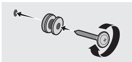
6. Installez les 2 **Support de fixation murale** selon l'orientation correcte en bas de la Soundbar, à l'aide de 2 **Vis**.
