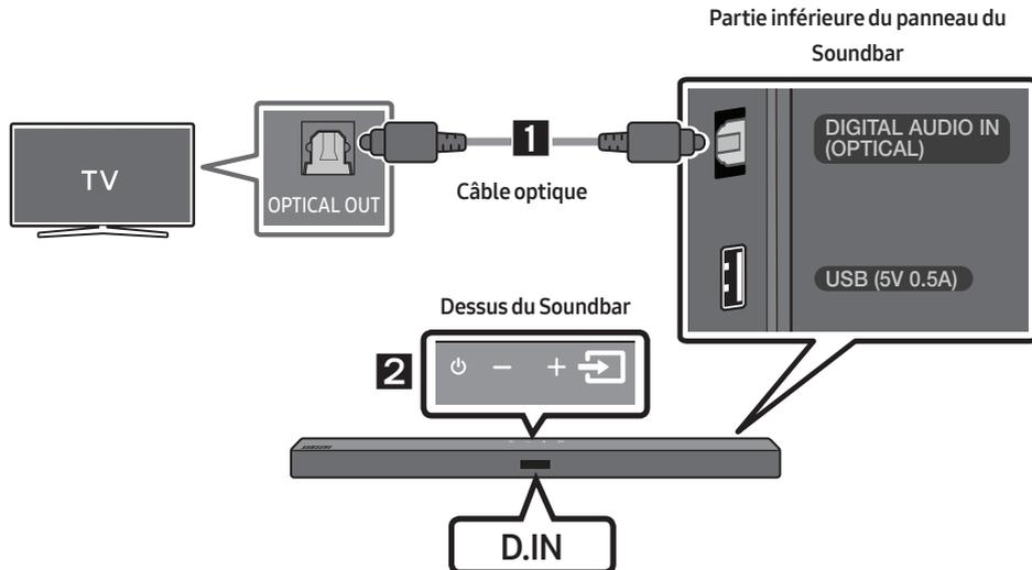
1. Branchez le connecteur **DIGITAL AUDIO IN (OPTICAL)** du Soundbar sur le connecteur OPTICAL OUT du téléviseur avec un câble optique numérique.
