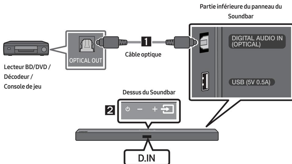
1. Branchez le connecteur **DIGITAL AUDIO IN (OPTICAL)** de l'unité principale sur le connecteur OPTICAL OUT du périphérique source à l'aide d'un câble optique numérique.
