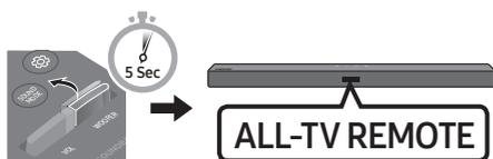
4. Si vous souhaitez retourner au mode par défaut du Soundbar (contrôlé par une télécommande de téléviseur Samsung), poussez le bouton **WOOFER** vers le haut et maintenez-le pendant 5 secondes jusqu'à ce que «**SAMSUNG-TV REMOTE**» apparaisse sur l'écran.
