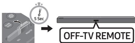
3. Si vous souhaitez contrôler le Soundbar à l'aide de la télécommande de votre téléviseur Samsung, poussez le bouton **WOOFER** vers le haut et maintenez-le pendant 5 secondes jusqu'à ce que «**ALL-TV REMOTE**» apparaisse sur l'écran. Ensuite, utilisez le menu du téléviseur pour sélectionner les haut-parleurs externes.
