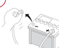
Para evitar potenciales cortocircuitos en el sistema eléctrico, asegúrese de desconectar el cable de la batería (-) antes de la instalación. Use esta unidad solo con una batería de 12 voltios y conexión negativa a tierra. De lo contrario, podría producirse un incendio o mal funcionamiento.
