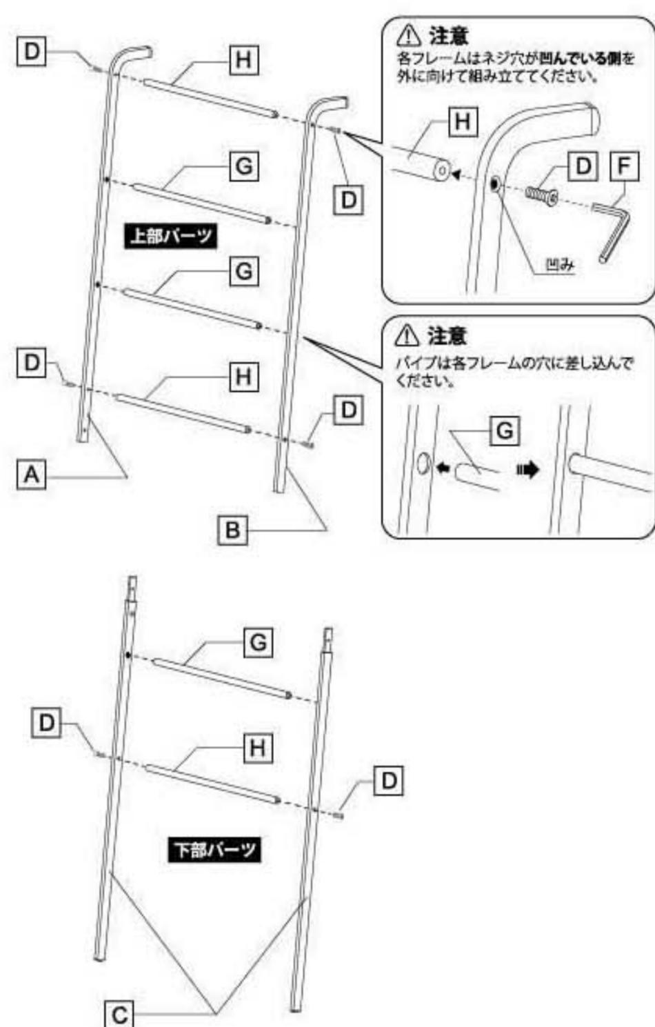
**2** 出来上がった下部パーツの接続パーツを上部パーツのフレームの穴に差し込み、六角レンチを使ってネジでしっかり固定してください。その際、下部パーツの六角ネジは最後まで締めず仮止めしてあるので、ネジの締め付け具合を調整して固定してください。
