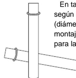
En tanto que el espacio entre los orificios de montaje puede variar según los diferentes vehículos, suministramos dos Varillas Adaptadoras (diámetro 12). Use estas Varillas Adaptadoras cuando los orificios de montaje del reposacabezas de su asiento sean demasiado grandes para las Varillas del reposacabezas con monitor.
