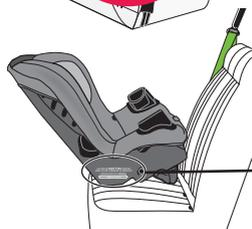
LA FLÈCHE DOIT ÊTRE NIVÉE AVEC LE SOL LORSQUE LE SIÈGE EST UTILISÉ FACE À L'ARRIÈRE
