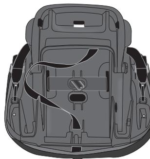
Lorsque le système DUA n'est pas utilisé, il **FAUT** attacher les crochets sous le dispositif de retenue pour enfant. Une courroie et un crochet DUA non attachés risquent de blesser l'enfant.
