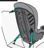
Décrocher le courroie d'ancrage de l'arrière du dispositif de retenue pour enfant et placer le crochet d'ancrage avec le **réglage rouge** (p. 50) par-dessus le dossier du siège du véhicule.
