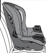
Régler le dispositif de retenue pour enfant en **position droite** (p. 44). Mettre le dispositif de retenue pour enfant dans le véhicule, en **orientation face vers l'avant**.
