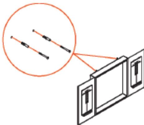
Étape 2: Sélectionnez une mèche qui est à peu près du même diamètre que les chevilles d'ancrage (no 5). Une fois les trous percés, utilisez un marteau pour insérer les chevilles d'ancrage (no 5) dans les trous. Une fois les chevilles d'ancrage (no 5) insérées, vissez les vis (no 2).
