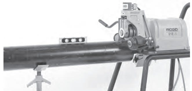
Figure 11 – Nivellement du tuyau
