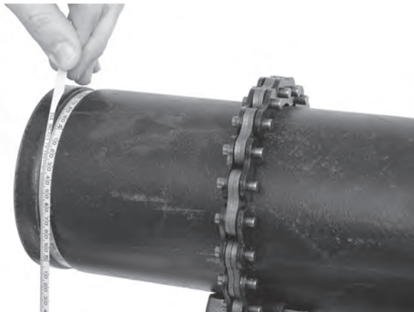
Abbildung 17 - Prüfen des Nutdurchmessers mit einem Durchmesserband
