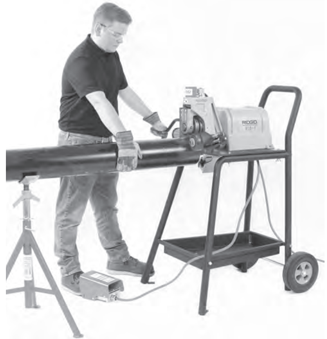
Abbildung 16 – Ausüben von Druck am Rohr
