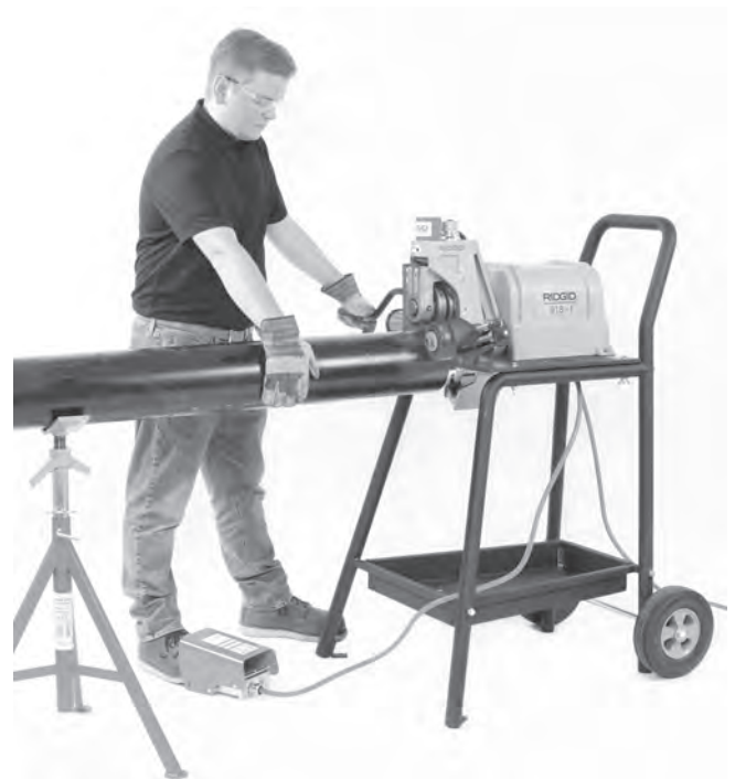
Figure 16 – Appuyer sur le tuyau
