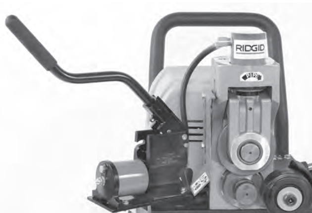
Figure 7B – Pompe en position de transport (rabattue)
