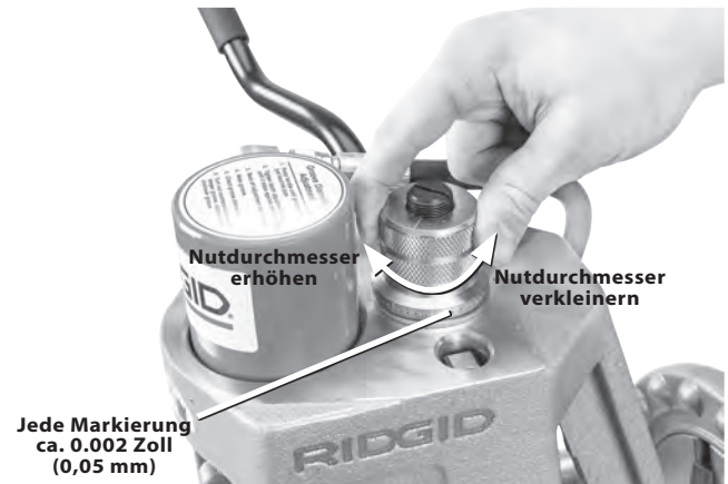
Abbildung 13 - Einstellung der Tiefeneinstellmutter
