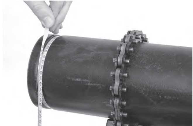
Figura 17 – Medición del diámetro en la ranura con la cinta de diámetros
