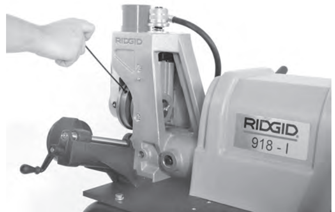
Figure 20 – Desserrage de la vis de blocage du galet de rainurage
