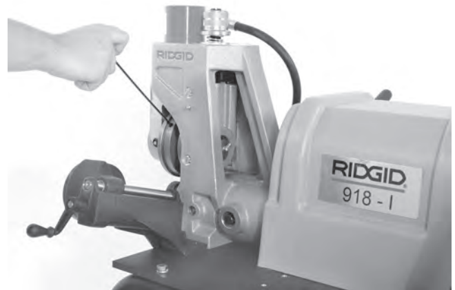
Abbildung 20 - Lösen der Stellschraube der Nutrolle
