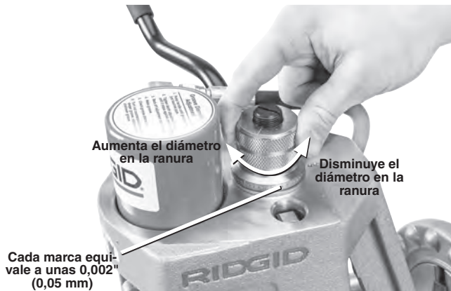
Figura 13 – Ajuste de la tuerca para fijar la profundidad
