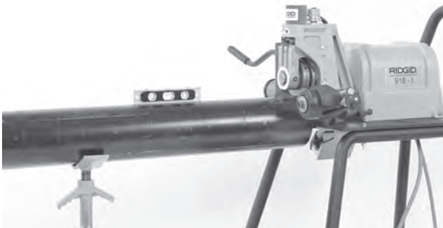
Figura 11 – Nivelación del tubo
