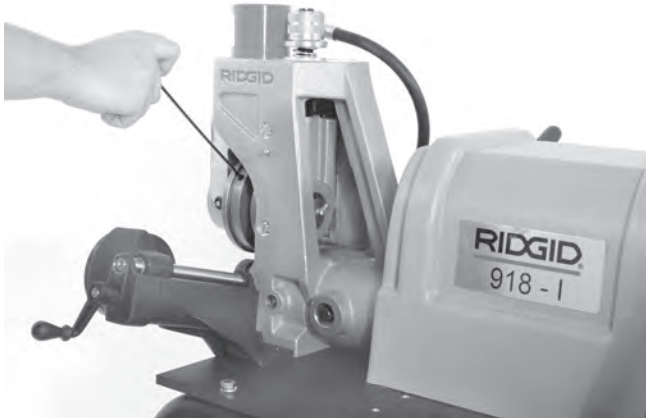
Figura 20 – Afloje el tornillo de montaje del juego de rodillos ranuradores
