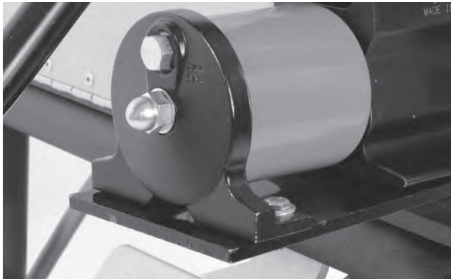
Figure 19 – Bouchon de remplissage d'huile
