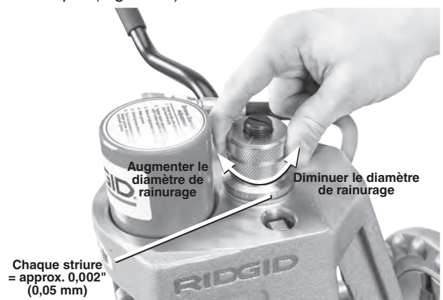
Figure 13 – Réglage de l'écrou de profondeur de rainurage
