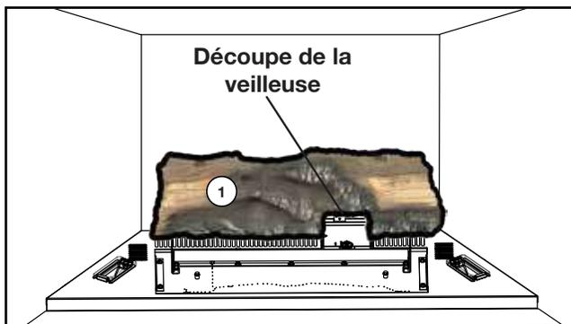
1. Placez la bûche n° 1 (W135-0685) au-dessus de la veilleuse et derrière les couvercles de circulation d'air.
