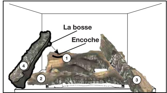
4. Placez la bosse de la bûche n° 4 (W135-0687) dans l'encoche gauche de la bûche n°1 en posant l'extrémité opposée sur la partie inférieure du bac à papier.
