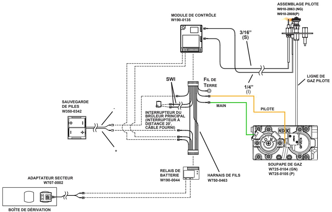
NOTE: BRANCHEZ L'ADAPTATEUR CA 3 VOLTS DANS LA BOÎTE DE JONCTION DE L'APPAREIL POUR ALIMENTER L'APPAREIL.
