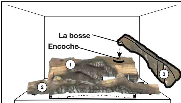
3. Placez la bosse de la bûche n° 3 (W135-0688) dans l'encoche droite de la bûche n°1 en posant l'extrémité opposée sur la partie inférieure du bac à papier.
