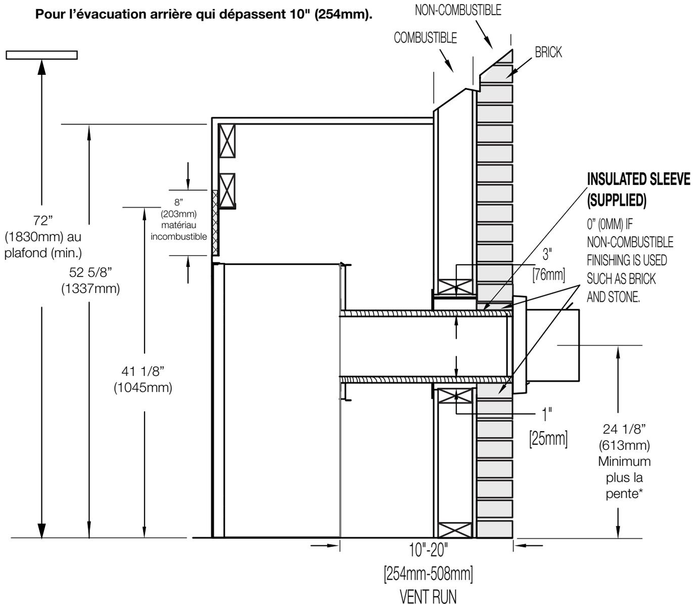
**Sections d'évents horizontales:** Un dégagement minimum aux matériaux combustibles de 3" (76mm) au-dessus hors de l'enceinte et 1" (25mm) sur les côtés et au-dessous hors de l'enceinte toute autour du conduit d'évacuation sur toutes les courses horizontales. Les sections d'évacuation horizontales dans les enceintes doit maintenir un dégagement minimaux de 3" (76,2mm) au-dessus du conduit d'évacuation.
