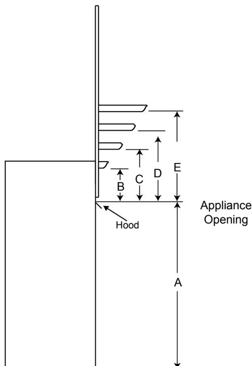
**UNIQUEMENT si le système de gestion thermique universelle est installé, les dégagements de la tablette peuvent être réduites.**
