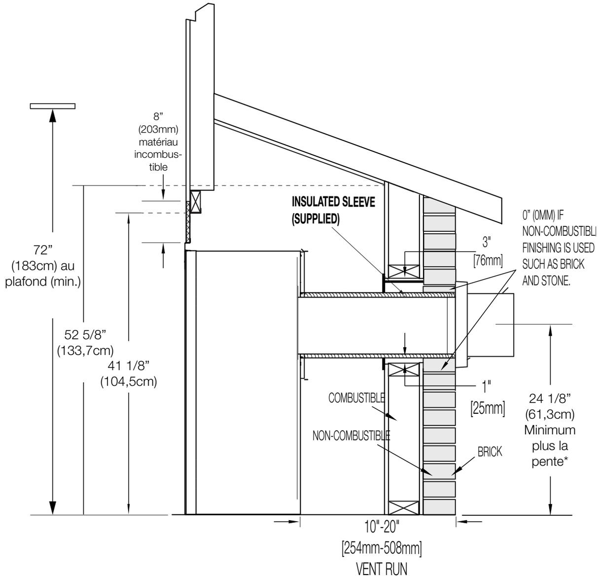
**Sections d'évents horizontales:** Un dégagement minimum aux matériaux combustibles de 3" (76mm) au-dessus hors de l'enceinte et 1" (25mm) sur les côtés et au-dessous hors de l'enceinte toute autour du conduit d'évacuation sur toutes les courses horizontales. Les sections d'évacuation horizontales dans les enceintes doit maintenir un dégagement minimaux de 3" (76,2mm) au-dessus du conduit d'évacuation.
