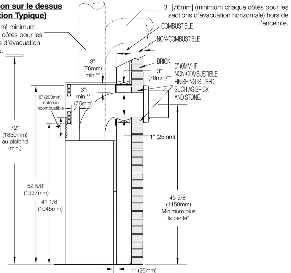
**Sections d'événements horizontales:** Hors de l'enceinte, un dégagement minimum aux matériaux combustibles de 3" (76mm) au-dessus et 1" (25mm) sur les côtés et au-dessous est requis toute autour du conduit d'évacuation sur toutes les courses horizontales. Dedans l'enceinte, les sections d'évacuation horizontales doit maintenir un dégagement minimum de 3" (76mm) au-dessus du conduit d'évacuation.
