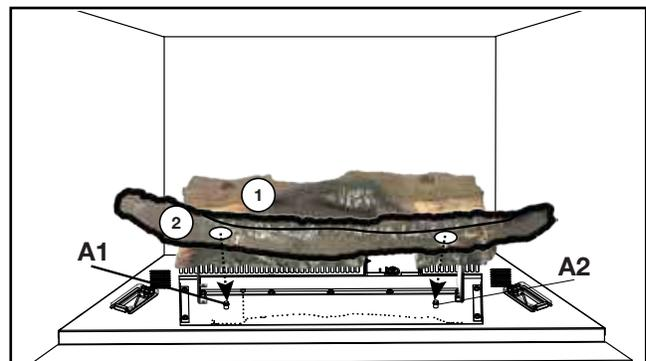
2. Placer les trous de positionnement de la bûche n° 2 (W135-0686) sur les goujons de positionnement A1 et A2 (c'est le bon moment pour placer les braises incandescentes).
