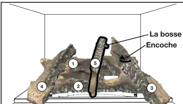
5. Placez la bosse de la bille n° 5 (W135-0690) dans l'encoche de la bille n° 3 en posant le « Y » sur la partie inférieure du bac à papier.
