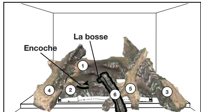
6. Placez la bosse de la bûche n° 6 (W135-0689) dans l'encoche de la bûche n° 2 en posant l'extrémité opposée sur la partie inférieure du bac à papier.
