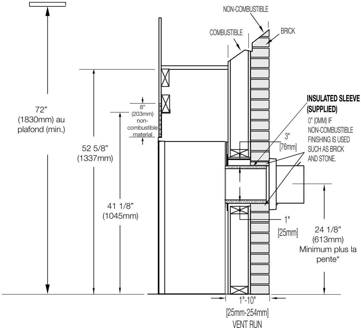
**Sections d'évents horizontales:** Un dégagement minimum aux matériaux combustibles de 3" (76mm) au-dessus hors de l'enceinte et 1" (25mm) sur les côtés et au-dessous hors de l'enceinte toute autour du conduit d'évacuation sur toutes les courses horizontales. Les sections d'évacuation horizontales dans les enceintes doit maintenir un dégagement minimaux de 3" (76mm) au-dessus du conduit d'évacuation.
