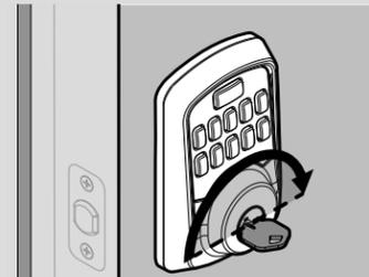
⚠ Si su puerta no se bloquea y desbloquea con suavidad, asegúrese de volver a colocar el pestillo anterior y golpee con los que se incluyen en la caja. Si aún experimenta errores de bloqueo, llame al servicio de asistencia de Kwikset para solicitar un kit de servicio de puerta deformada.
