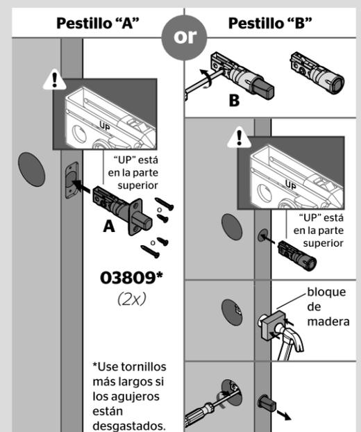
**C** ¿Esta el orificio en forma de D centrado en el orificio de la puerta?
