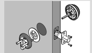
**C** Mida para confirmar que el orificio en la puerta sea de 54 mm (2-1/8") o 38 mm (1-1/2").
