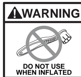
\*\*La valve clé doit être utilisée SEULEMENT pour serrer ou remplacer la valve lorsque le SUP est dégonflé. Il ne devrait jamais être utilisée lorsque le SUP est gonflé.
