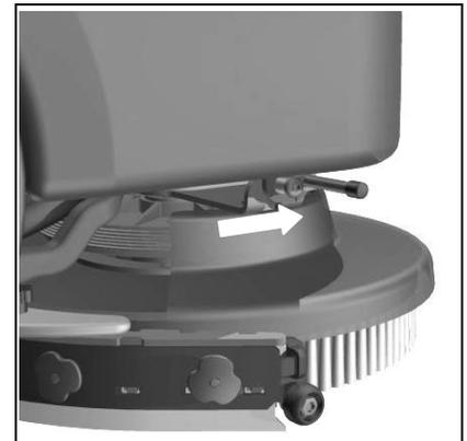
4. Desenganchar la bancada utilizando el pedal
