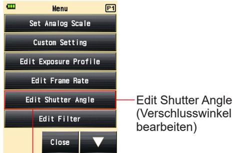
Bildschirm „Edit Shutter Angle“ (Verschlusswinkel bearbeiten)
