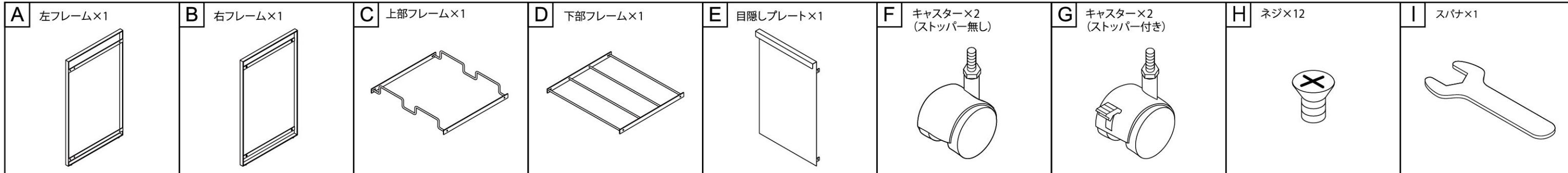
1 下図のように左右のフレームに上部フレーム、下部フレームをネジでしっかりと固定してください。
