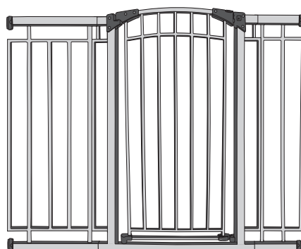
4 110,5 - 121,9 cm (43,50 - 48 po) avec petite et grande extensions de cadre
