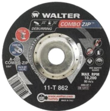
COMBO ZIP<sup>MC</sup> est la solution idéale lorsque les opérateurs ne veulent pas s'embêter à changer de meules pour ébarber, entailler ou chanfreiner immédiatement après la coupe. D'une épaisseur de seulement 5/64", cette meule de tronçonnage résistante est hautement renforcée. Gagnez du temps et améliorez la sécurité des travailleurs avec ce disque à tronçonner polyvalent.
