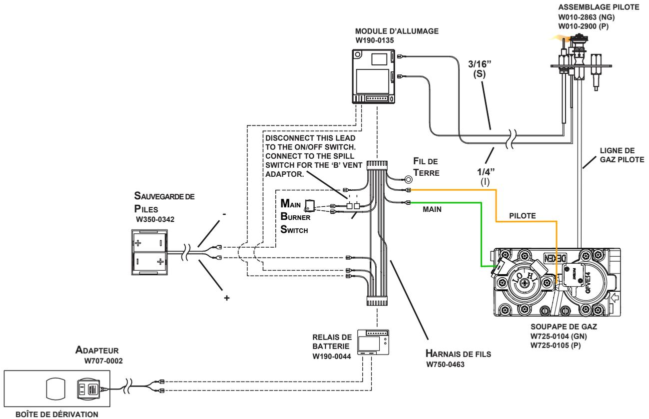
NOTE: BRANCHEZ L'ADAPTEUR CA 3 VOLTS DANS LA BOÎTE DE JONCTION DE L'APPAREIL POUR ALIMENTER L'APPAREIL
