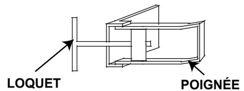
Dans certains cas, la tension des loquets devra être ajustée pour assurer une meilleure étanchéité. Desserrez et resserrez simplement chaque loquet, jusqu'à ce que les deux loquets s'enclenchent lorsque vous fixez la porte.
